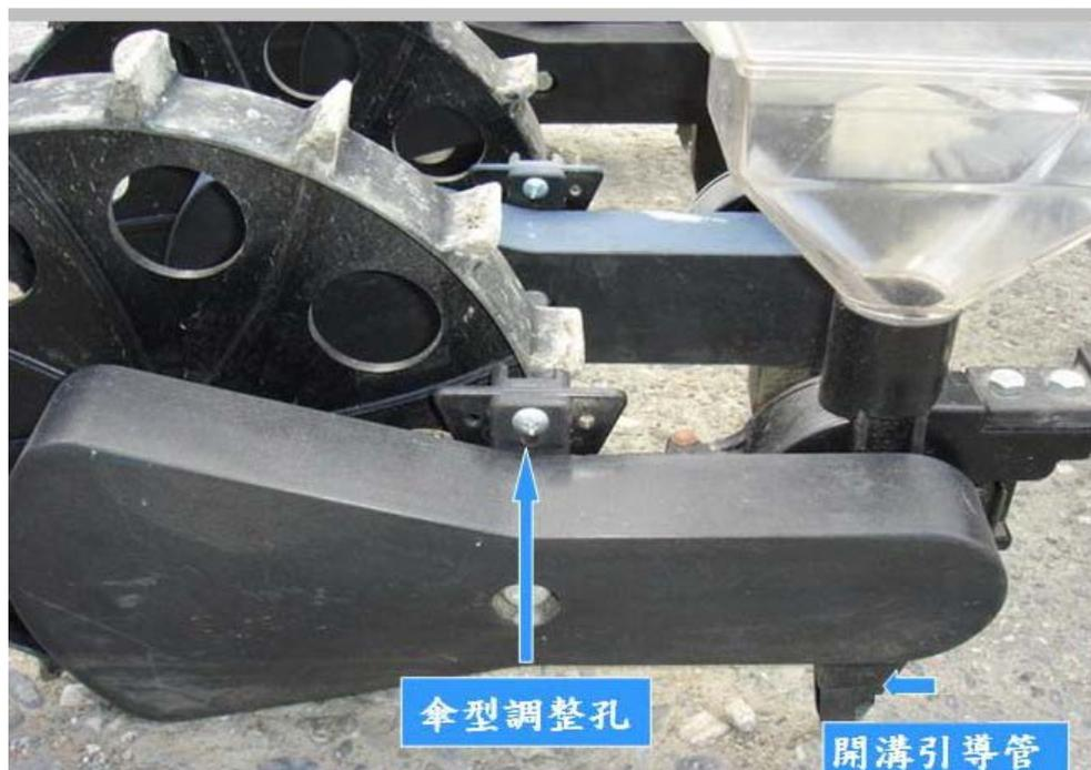
圖五、播種深度調整
