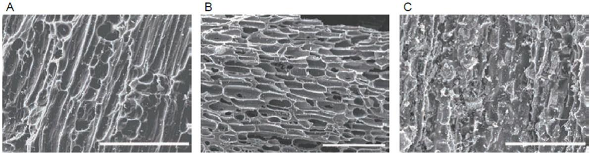
1 電子顯微鏡下之生物炭的表面和孔隙結構圖，
