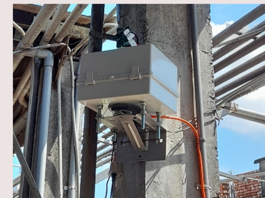
❖ 本場研發雷射驅鳥裝置除了可在農田使用外，在機場及養豬場亦有效用，未來將依照環境不同，再進行使用效期的改進（上圖為養豬場的雷射驅鳥裝置）
