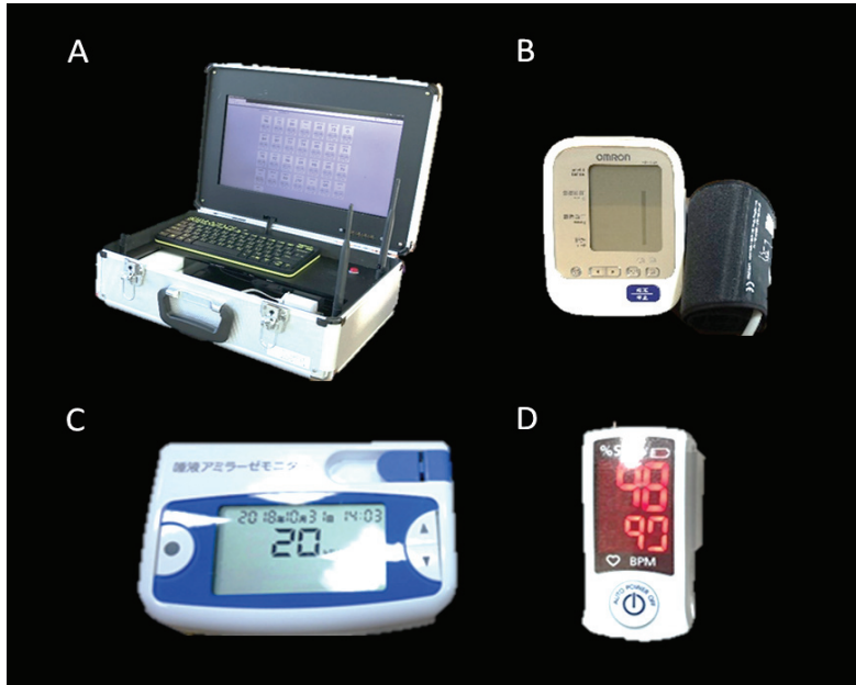
圖二、生理數據量測儀器(A)心率監測儀、(B)血壓計、(C)唾液澱粉酶測定儀、(D)血氧濃度計 Fig. 2. Physical index instrumentation. (A) Heart rate monitor, (B sphygmomanometer), (C) Hand-held SAA monitor, (D) Pulse Oximeter.
