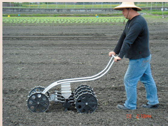
▲手推式蔬菜種子直播機在田中操作情形
