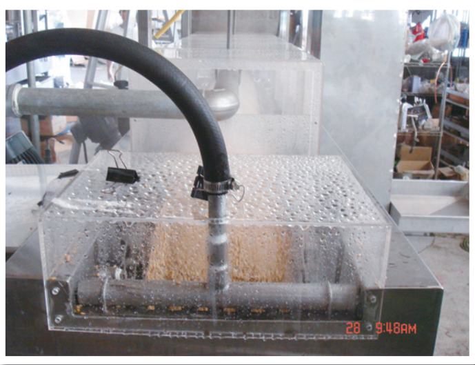
種子溫湯消毒設備之保溫視窗罩結構
