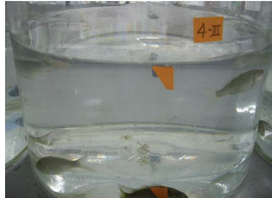
圖 4. 以鯉魚進行魚毒測試評估水生生物毒性
