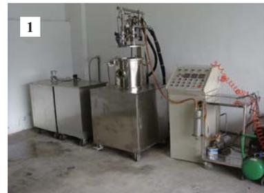
並設置離心旋轉槽可容置種子袋，藉由溫湯槽與冷、熱水槽、真空泵浦、鼓風機、排水管、排氣管、溫度控制系統及微電腦控制器等之結構連結，可將熱水導入溫湯槽進行瓜果種子的消毒，並經由脫水、烘乾程序取出無菌的瓜果種子。
