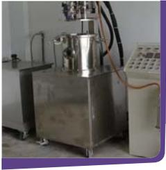
連結所控制操作。首先將種子袋放入離心旋轉槽之各容槽中，再由槽蓋鎖固而將種子袋定位於容槽的內部，控制箱下降上蓋與溫湯槽結合，固定夾鎖固上蓋而形成密封，啟動離心旋轉槽轉動並將溫湯槽內的空氣經由真空泵浦抽取出，使種子袋內的一部份雜質先行排出，讓種子的毛細孔形成真空狀態（負壓），此時在關閉真空泵浦及其管道後，熱水槽的泵浦將熱水注入溫湯槽並加壓（正壓）浸泡瓜果種子（熱水的溫度經由循環、加熱器加熱而保持恆溫，壓力經熱水槽泵浦的輸入而形成加壓），使瓜果種子在離心旋轉槽的轉動中被熱水強力沖洗、揉搓，達到充份洗淨的效果，讓熱水藉由加壓而更順利滲透入瓜果種子的毛細孔進行洗淨、殺菌、消毒。直至熱水浸泡、沖洗的時間完成後，即可由排水管排出熱水並啟動冷水槽之泵浦，讓溫湯槽一邊排出熱水一邊注入冷水而冷卻、浸泡，讓旋轉中的瓜果種子瞬間快速藉由冷水而降溫、洗淨雜質，等到冷水停止注入並完全排出後，啟動鼓風機注入熱風、開啟排氣管，不僅可由離心旋轉槽的旋轉離心力
