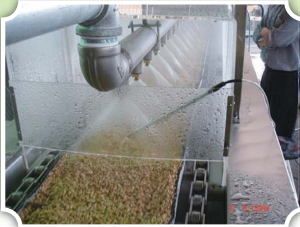
稻種溫湯消毒機進行溫水噴灑情形
