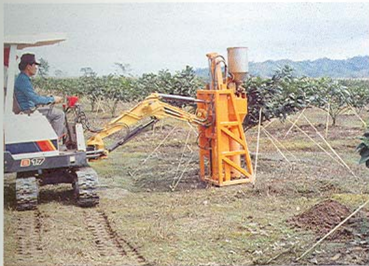
相片 2. 利用小型挖土機承載立體施肥機
