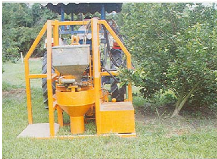
相片 1. 利用曳引機承載果樹立體施肥機 Photo1. Vertical fertilization applicator driven by the tractor
