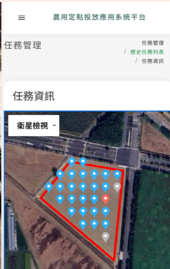
▲雲端操作平台可自動計算田區面積和蜂球投放座標
