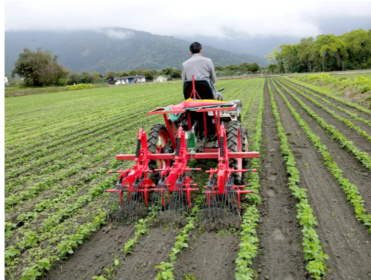
圖 2、乘坐式機械除草操作輕鬆效率高
