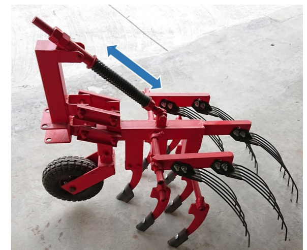
圖 5、調整鎮壓彈簧壓縮量，提供適度的向下壓力，穩固除草深度
