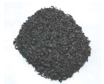
▲圖五、炭化程度均一且維持稻殼原本形狀的炭化稻殼
