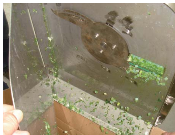
▲切菜刀對應輸送裝置切削位置，切削時外側保持向下朝內方向切削，保持完整截切斷面，減少汁液滲出
