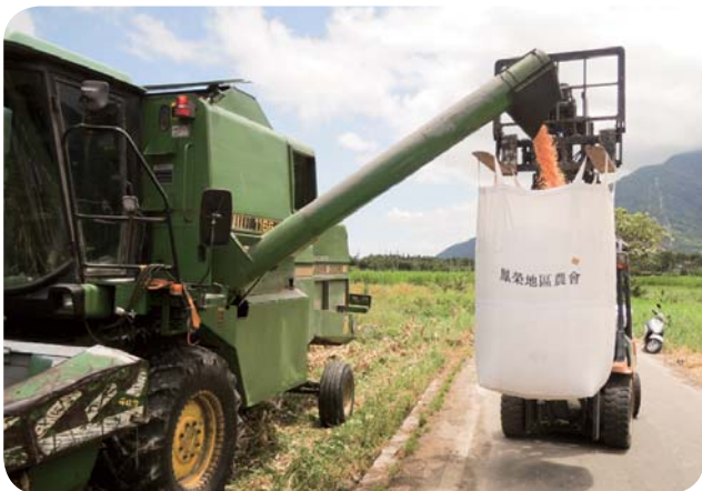
▲機械採收硬質玉米脫粒並裝於太空包
