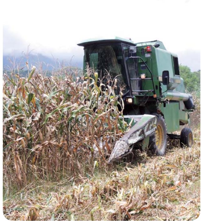
▲機械收穫進行採穗、去苞葉及脫粒等一貫作業採收玉米
