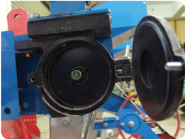
▲播種盒結構，連接種子箱與落種孔
