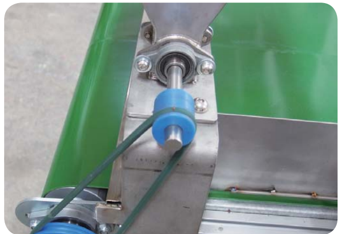
▲螺旋出料的傳動結構
