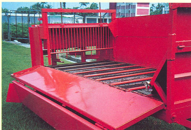
▷ 圖一、上下層肥料承裝側板打開後內部構造
