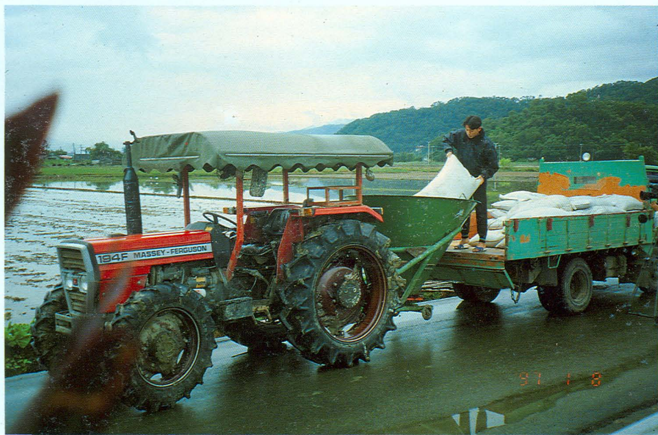
■圖三 利用貨車台架上配合倒肥作業情形
