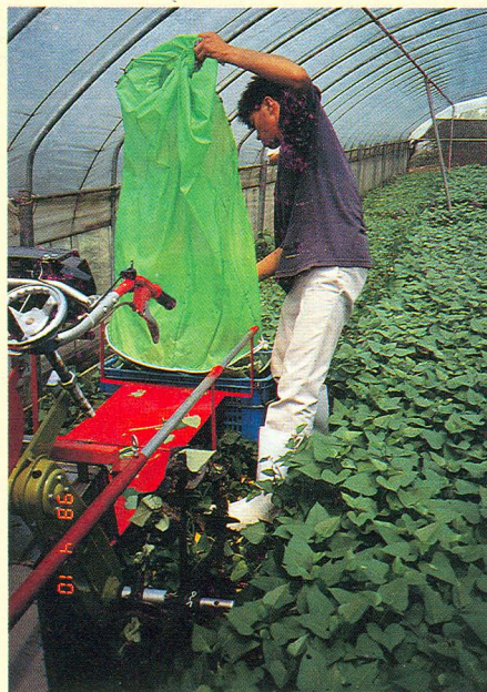
←機械採收由引擎帶動風扇將甘藷葉吹至收集網袋中
