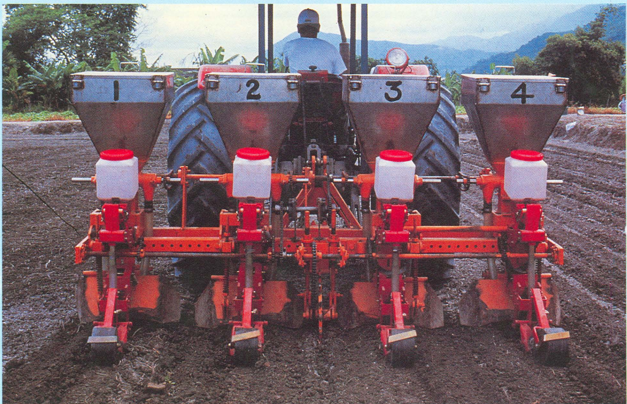
↑玉米播種、深、淺雙層施肥兼施藥多功能作業機田間作業情形。
