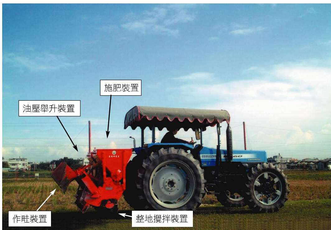
▲圖一、曳引機承載施肥作畦一貫作業機
