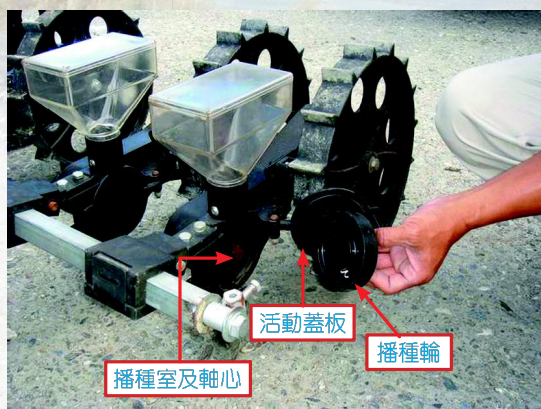
▲更換合適播種輪安裝情形
