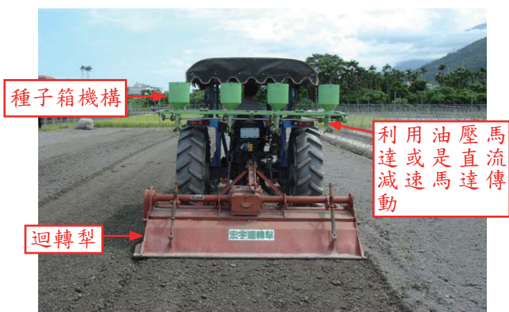
圖二、油壓式或機電式播種整地覆土一貫化作業
