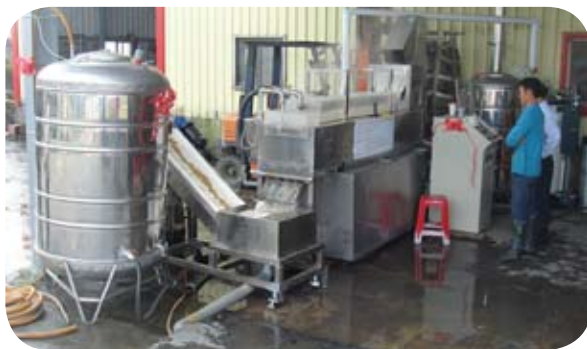
▲連續式稻種溫湯消毒機進料、消毒、冷卻、出料、收集
