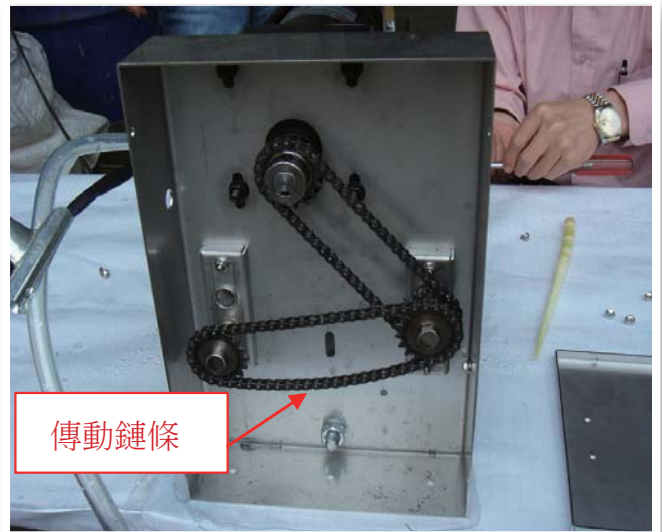
圖三、剝殼滾筒另端減速馬達鏈條驅動
