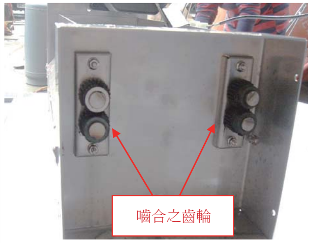
圖二、剝殼滾筒的一端設有嚙合之齒輪
