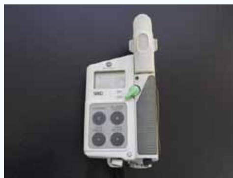
▲圖一、葉綠素計(chlorophyll meter, SPAD-502)用於測量作物葉片葉色，並以數值方式表示葉色濃淡。
