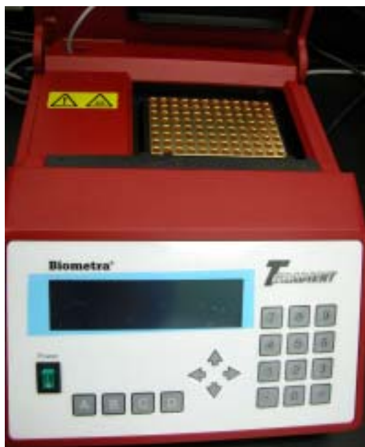
▲圖二 PCR 機器，上方的金色方形金屬即為樣本管置入之處，可以控制溫度
