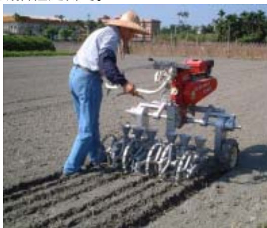
▲圖 4 承載型適用平地或跨在畦上作業，機身高度及行走寬度皆可配合調整
