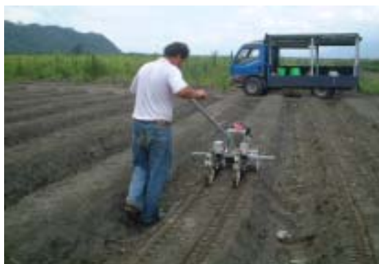
▲圖 7 輕巧型直播機田間機播藥草種子作業情形
