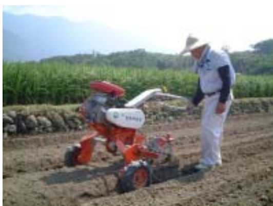
▲圖 3 承載固定跨在畦床上作業播種時並可同時配合覆蓋，利用機械力取代人力
