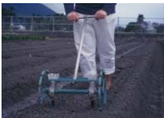
▲圖 1 二行式手推機播白蘿蔔，解決人工播種作業之辛勞
