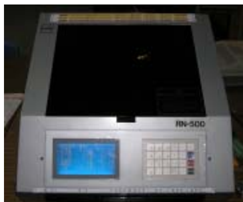
▲可以評估米粒外觀品質之米粒判別機
