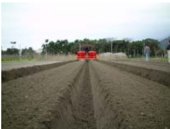
▲圖 2 利用三組開溝器完成一次二全畦田間作業情形
