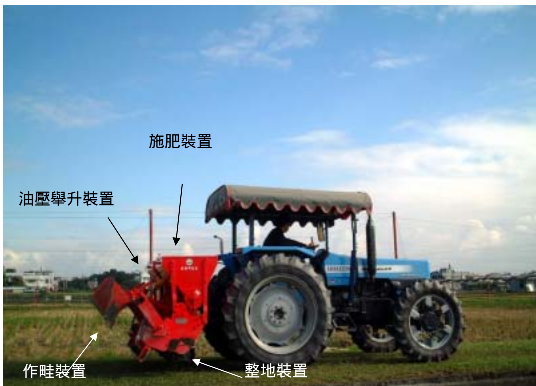
▲圖 1 曳引機承載施肥作畦一貫作業機
