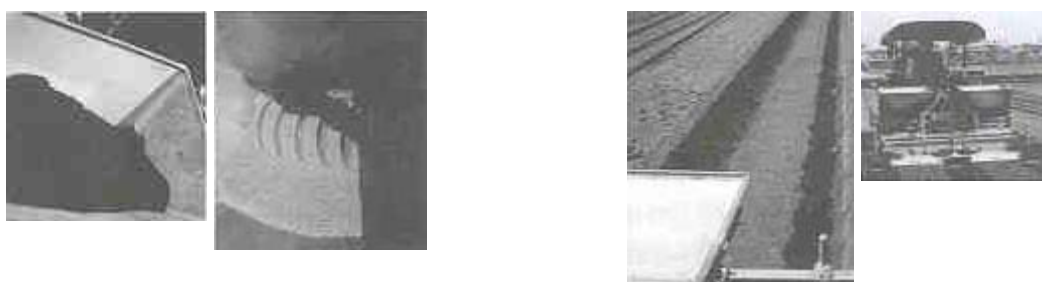
作畦施肥機分別填裝有機肥料及化學肥料以及攪拌情形
