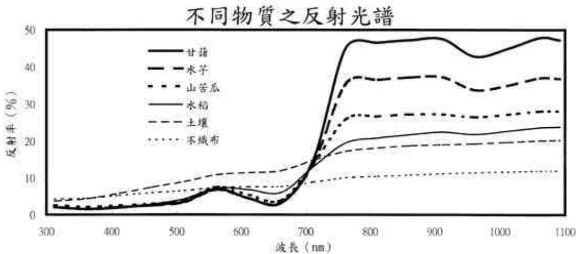
國內將光譜分析技術應用於水稻生長的偵測尚在起步階段，一般以利用 600-700 nm 及 700-800 nm 波段的反射值來區分水稻的生長期，利用 700-800 nm 波段的反射值區別粳稻、籼稻和糯稻，其他還有利用衛星影像結合各種波段及植被指數估算水稻栽培面積、產量、旱害等級、受災範圍區分與氟化物污染之逆境調查等。
