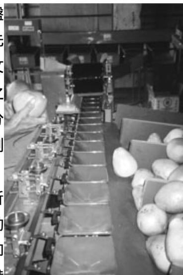
旦再逐粒輸送至重量式分級機分級。為了使周邊輸送設備鏈輪速度與重量式分級機之秤盤速度同步，周邊輸送設備之鏈輪直接由重量式分級機馬達所驅動。
