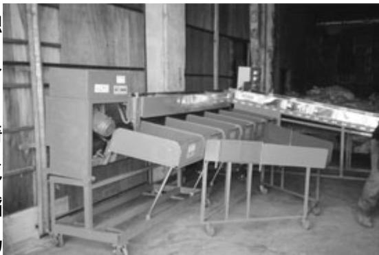
無分級機，市面上標示可同時應用於文旦分級的機械如滾軸式分級機，其機構乃針對較圓形之蔬果研製，大部分應用於柑橘類水果之分級，國內未見有人使用於分級文旦。其他如重量式分級機則廣用於蔬果分級，花蓮縣瑞穗鄉農會曾先後採購六台用於文旦分級，但除分級部分是採用機械外，進料部分是以人工撿拾再排列於秤盤上，仍相當耗費人力及成本，故目前棄置不用，分級仍舊全部採人工方式進行。有鑒於此，本場研改現有之滾軸式分級機及重量式分級機並研發搭配兩機使用之周邊輸送設備，期能以機械方式分級文旦，取代傳統人工分級方式以提高工作及分級效率、降低生產成本。
