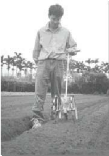
圖一、單行雙輪式直播作業器，對蘿蔔之種植有良好效果
