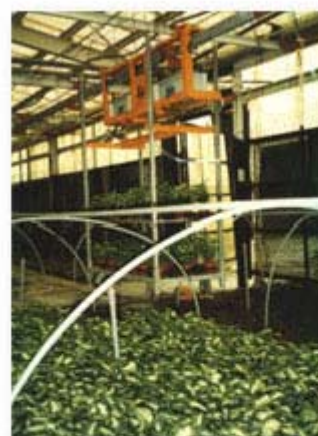
「吊盆類觀葉植物自動化栽培示範中心」特採用懸掛型軌道搬運系統，可將台車直接吊起使用，以配合設施內吊盆類觀葉植物之立體式栽培，提高設施內部栽培空間之利用率
