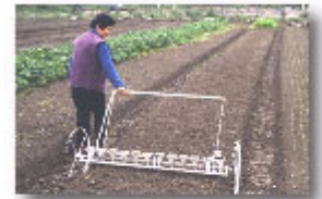
本場開發完成之直播機具，田間作業情形本機具構造簡單，作業輕巧
