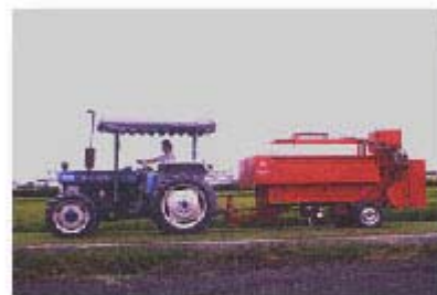
本場為配合有機農業發展而研發成功之有機質肥料撒播機
