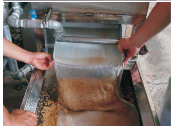
▲ 連續式種子溫湯消毒機之殺菌裝置(上)、冷卻裝置(中)以及出料收集(下)
